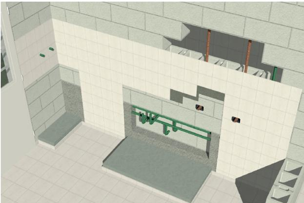
En la mampostería de BH no se deben canaletear ni perforar los mampuestos para distribuir la cañería sanitaria y de electricidad. Para ello se generan "nichos" usando **BH** de distintos anchos.
