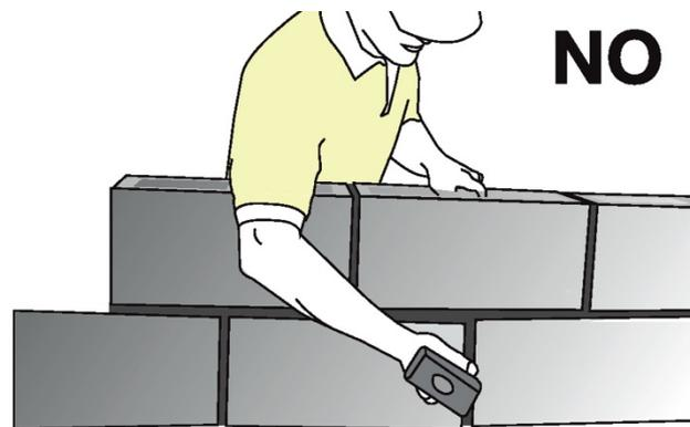
Cualquier bloque que haya sido movido luego de que la mezcla haya endurecido, debe ser totalmente removido y recolocado con mortero fresco.
