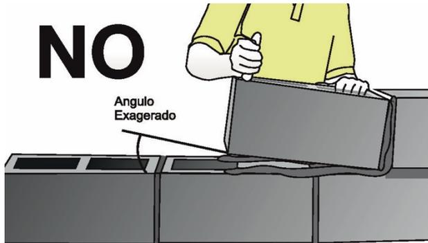
Todos los cambios de posición del BH deben ser hechos antes que el mortero comience a fraguar. La realineación de un bloque fuera de posición no debe intentarse luego de haber colocado la hilada o hiladas superiores.
