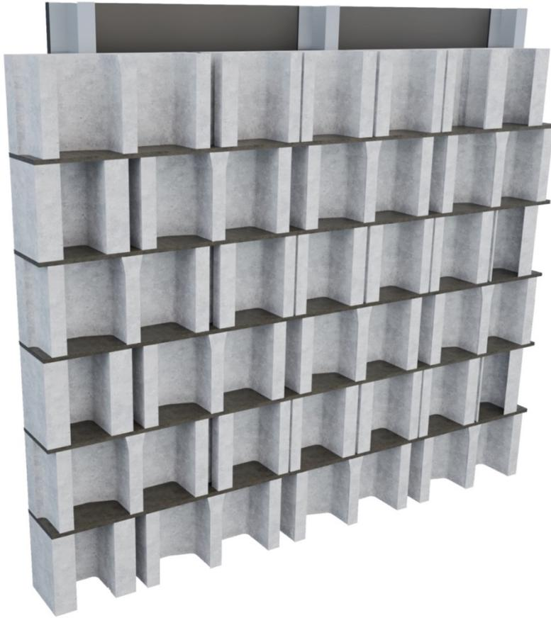
Esquema de un corte o sección de un muro de bloques de hormigón de una sola hoja (muro simple) en donde se observan los tabiques transversales (puentes térmicos) y los huecos verticales que quedan dentro del muro una vez construido con bloques 20x20x40 de dimensiones estándar (bloque portante según norma IRAM 11561 "Bloques de hormigón. Parte 3 - Requisitos de los bloques portantes").
