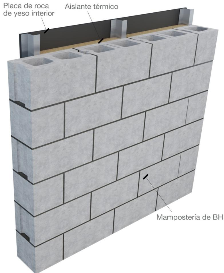
La cara exterior queda expuesta. Como en todos los casos, el valor de la resistencia térmica se puede aumentar, por ejemplo, rellenando los huecos vacíos de la pared de bloques.
