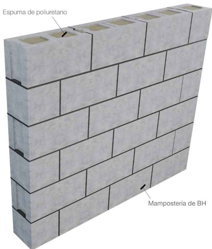
En este caso la mampostería queda expuesta tanto en el interior como en el exterior, y el aislante térmico utilizado es poliuretano inyectado in-situ. También se podrían usar otros materiales aislantes para rellenar los huecos verticales, tales como perlita, vermiculita o arcilla expandida, cada uno con sus propios valores de R.
